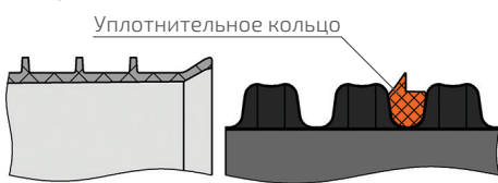
Рисунок А. Установка уплотнительного кольца для труб DN 250–1200 мм
